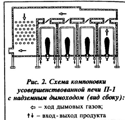
каркас печи наваривается кожух, к которому крепятся блоки (максимальный размер 1680×1300 мм) из жаростойкого бетона. Блок — несущая рама (из уголка) и арматурные элементы (из жаропрочной стали) устанавливаются несущей рамой к кожуху печи. Стыки между блоками выполняют роль термшвов и заделываются материалом, аналогичным составу блоков. Такая схема лучше выдерживает термоциклы и более ремонтопригодна.
