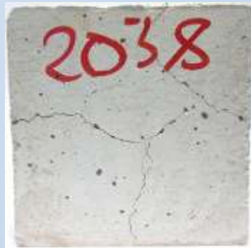
Образцы бетона с низкой термостойкостью (менее 7 теплосмен)
