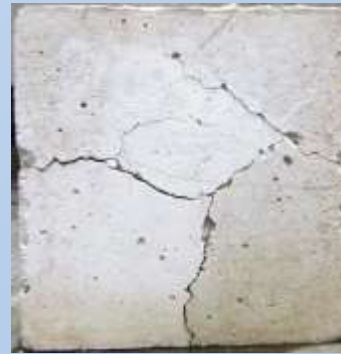
Образцы бетона с низкой термостойкостью (менее 7 теплосмен)
