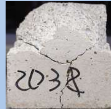
Образцы бетона с низкой термостойкостью (менее 7 теплосмен)
