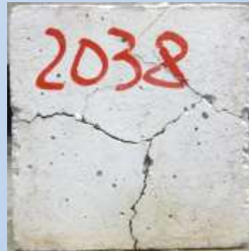
Образцы бетона с низкой термостойкостью (менее 7 теплосмен)
