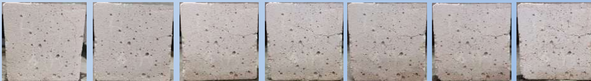
Образцы бетона с высокой термостойкостью (более 30 теплосмен)
